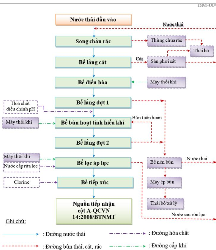
Hình 1 Sơ đồ công nghệ xử lý nước thải sinh hoạt của khu dân cư A sau khi hoàn thiện.
