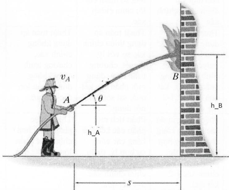
Viết chương trình Matlab khảo sát chuyển động của dòng nước từ vòi phun để nước phun từ điểm A đến chính xác điểm B với các thông số sau được nhập vào từ bàn phím:  $v_A$ ,  $h_A$ ,  $h_B$ ,  $s$ . Khảo sát trong các trường hợp:
